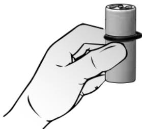
Replacing dosing piston seal (**Fig. 20a**):
