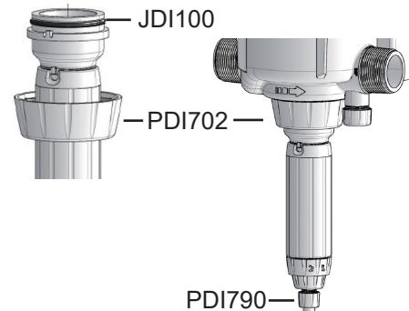
Corter 1 pulgada en línea recta, de la punta de la manguera de succión. Sujete la manguera a la lengüeta y atornille la tuerca de la manguera de succión (PDI790).
