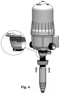
Si es necesario, para visualizar mejor las clavijas, desenroscar la tuerca de ajuste hasta la mitad. (Fig. 4)
