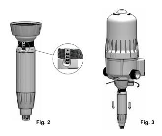
Aflojar a mano la tuerca de fijación de la parte de dosificación para llegar a ésta tirando hacia abajo, y girar media vuelta para ver la escala correcta de ajuste (Fig. 3).
